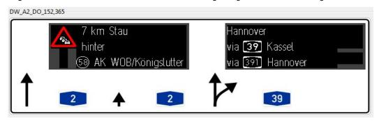
Dieses Beispiel zeigt die Anzeigeinhalte bei einem Stau auf der A 2 in Fahrtrichtung Dortmund zwischen dem AK Wolfsburg/Königslutter und dem AK Braunschweig-Nord. (In diesem Fall bei einer Staulänge von 7 km hinter AK Wolfsburg/Königslutter und Stauwarnung mit VZ 114). Als Verkehrslenkungsempfehlung für den Verkehr mit dem Fernziel Hannover wird eine Alternativroute zur Umleitung des Verkehrs über die "kleine" Netzmasche im Raum Braunschweig über die A 39 und A 391 angeboten.
